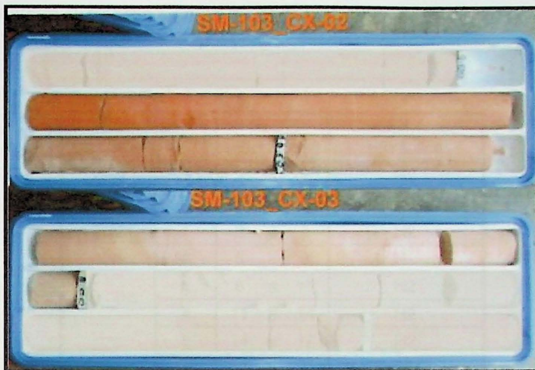
Foto 7 - Testemunho de arenito fino C2, F2 e permeabilidade H2
