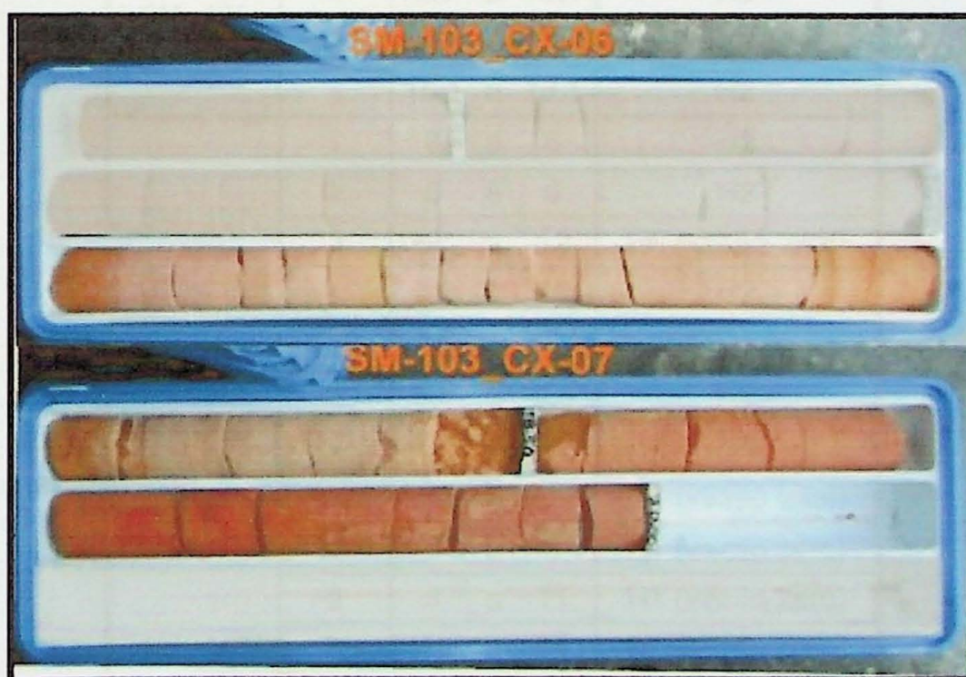
Foto 8 - Testemunho de arenito fino C4, F4 e permeabilidade H5.
